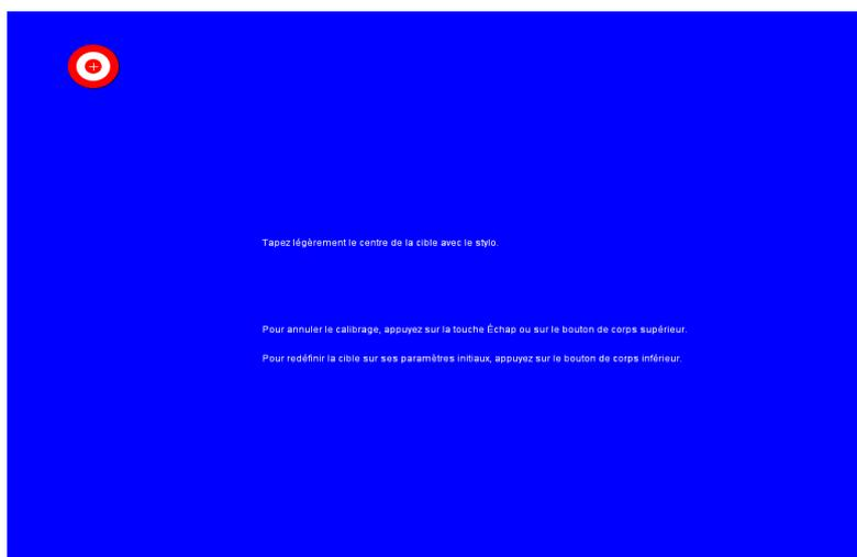
**Remarque** : une méthode plus rapide permet d'effectuer le calibrage : appuyer sur le bouton raccourcis présent sur le tableau. On arrive dans ce cas directement à l'écran avec les cibles.
